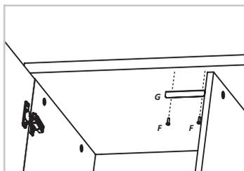
8. Parafuse a chapa trava/ batente utilizando a porta para auxiliar no posicionamento.
