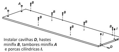
Instalar cavilhas **D**, hastes minifix **B**, tambores minifix **A** e porcas cilíndricas **I**.
